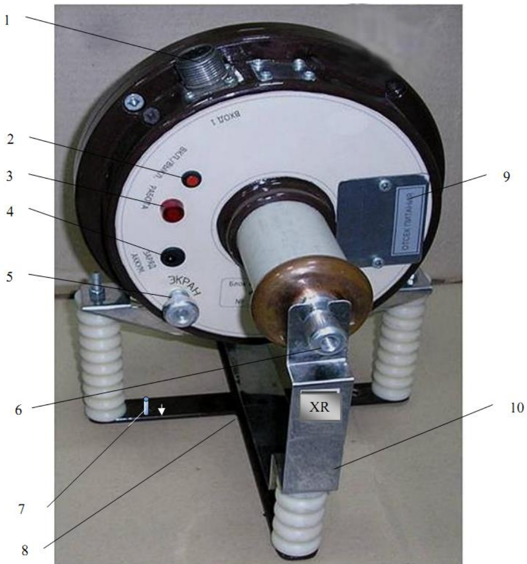
Рисунок 1.2 Блок высоковольтный ИПИ-10-МОЛНИЯ-БВ. Внешний вид.
